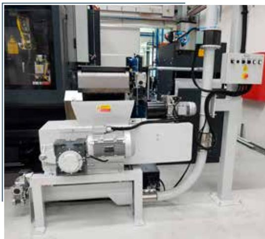
Stazione di aspirazione dotata di trituratore per trucioli di acciaio
