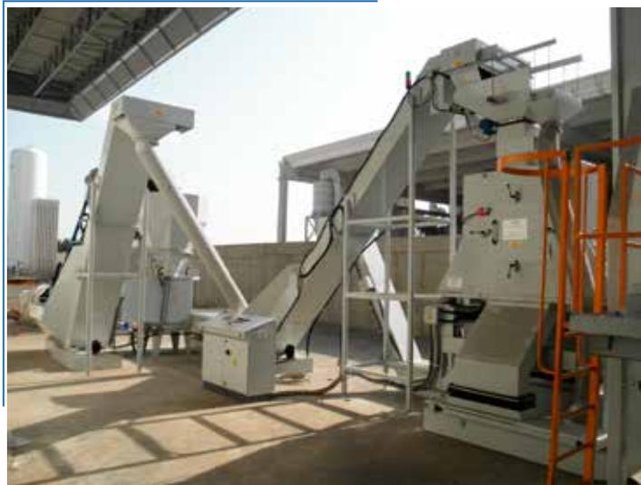
Gli impianti per il trattamento dei trucioli sono sistemi modulari, atti alla triturazione, alla centrifugazione e allo stoccaggio del truciolo.
