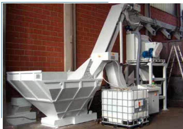
**Sistema di centrifugazione per trucioli di alluminio**
