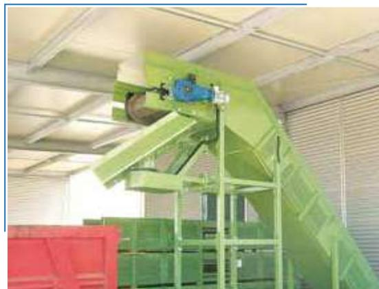
Dettaglio dello scarico in container
