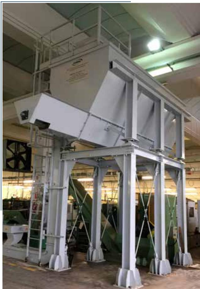
**Silos orizzontale dotato di celle di carico**
