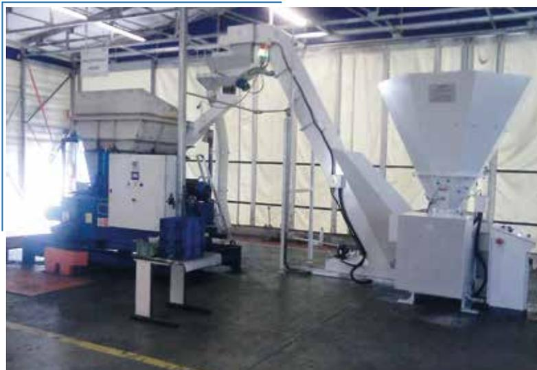
**Impianto di triturazione e bricchettatura per trucioli di alluminio**
