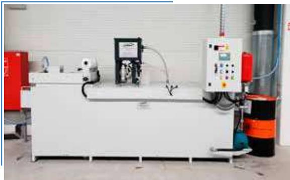
Sistema centralizzato di filtrazione per emulsioni dotato di filtro a carta, disoleatore e sistema di dosaggio e rilancio
