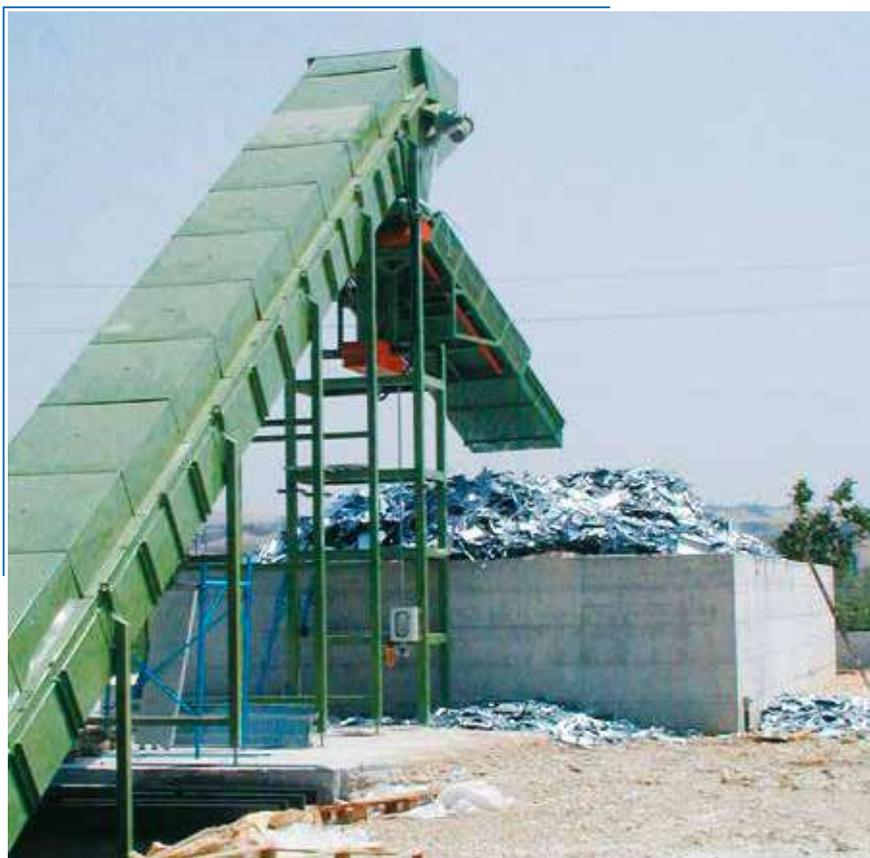
Trasportatore terminale di una linea per il trasporto di sfridi metallici
