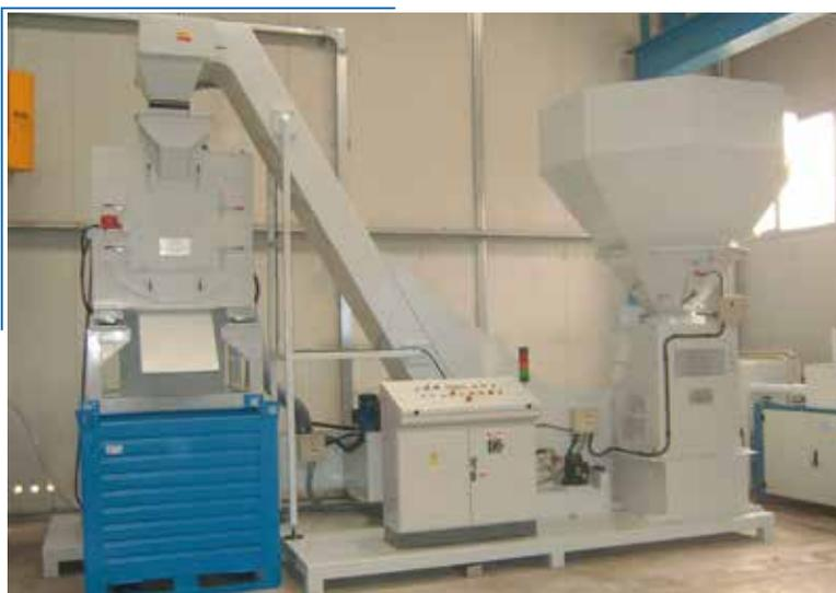
**Impianto di triturazione e centrifugazione per acciaio inox**
