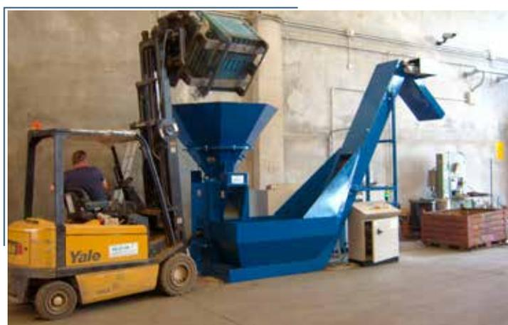
Sistema di triturazione con separatore magnetico
