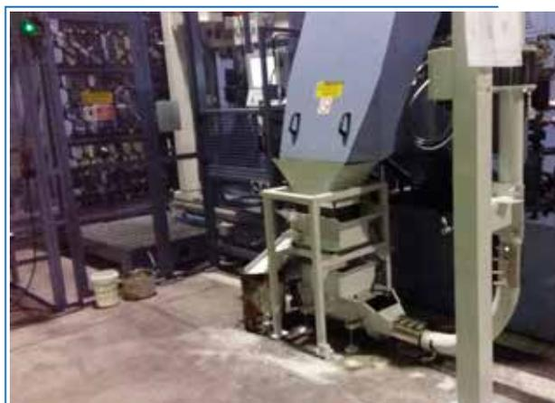
Stazione di aspirazione dotata di vibrovaglio per l'espulsione di pezzi
