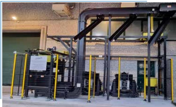
**Due stazioni di scarico, doppia centrifugazione, triturazione e containerizzazione di ottone ed inox**
